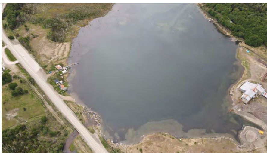
Imagen 31: Vista aérea del aserradero Bronzovich en Lago Escondido, donde se elevó el nivel del agua por obturación de su desagüe (Izquierda) para acercar el lago al aserradero (Derecha).
