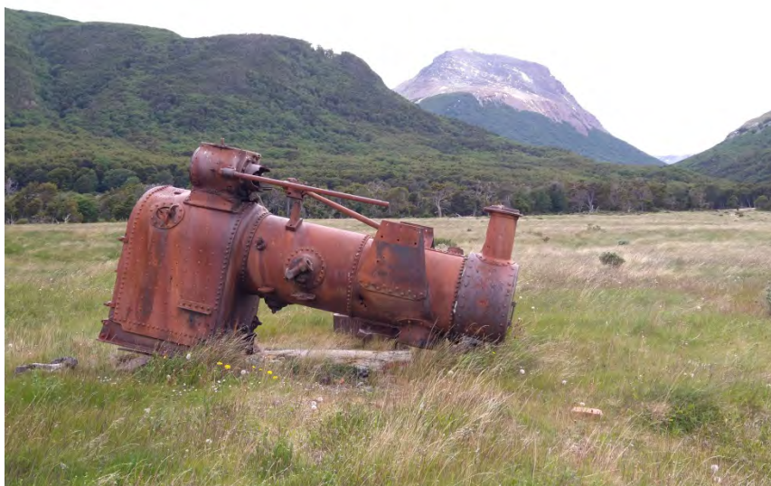
Imagen 13: Restos de una máquina de vapor (Locomóvil) que se utilizaba para accionar un aserradero en Estancia Remolino, sobre la costa del canal Beagle.
